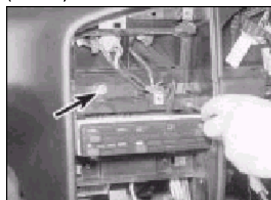
9.22 Odstranění šroubu ovládaní topného tělesa - modely od roku 1993
