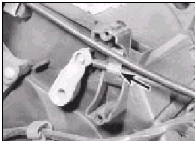
9.28 Kovová pružinová příchytka (šipka) táhla na topném tělese
