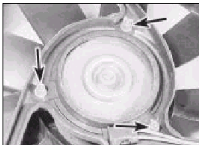
5.7 Šrouby motoru ventilátoru (šipka) – pohled ze zadní části (čelní strana masky chladiče)
