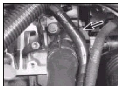
4.4b Kryt pouzdra termostatu (šipka)- 2,0 litrový motor.
