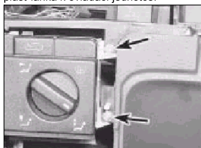
9.10 Dva šrouby ovládací jednotky topného tělesa (šipky) – modely do roku 1992
