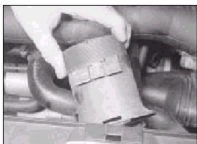
3.5b . . . a odstraňte přívod vzduchu
