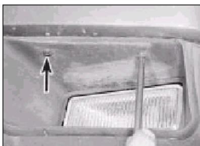
7.16 Odstranění šroubu zajišťující kryt předního přídatného mlhového světla
