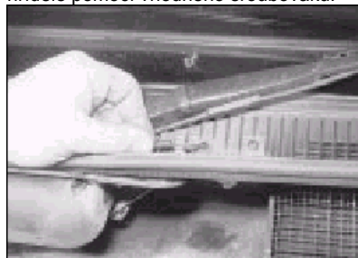
16.2 Odpojení hadičky ostřikovačů ze spojky
