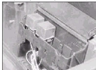
3.14d Box relé v oddělení motoru - modely do roku 1992
