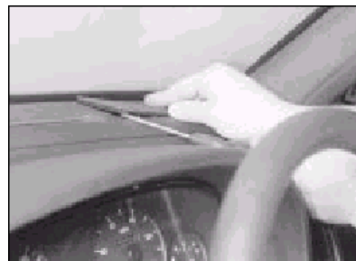
21.9a Vypáče kryt reproduktoru z přístrojové desky . . .
