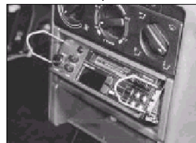
20.3 . . . pak vsuňte demontážní nástroje . . .
