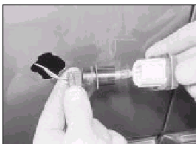
5.20 Odstranění objímky z postranního ukazatele směru
