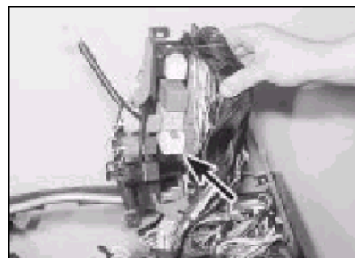
13.3 Bzučák světel (šipka)- modely od roku 1993 (pohled na odstraněnou a obrácenou přístrojovou desku)
