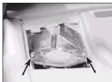
21.7 . . . pro přístup k šroubům reproduktoru - modely do roku 1992
