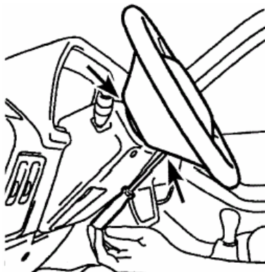
25.7 Otočte volantem pro přístup k dvěma šroubům airbagu (viz šipka)
