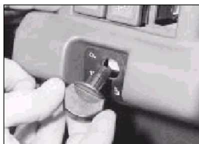
9.5 Vytáhněte seřizovací knoflík předních světlometů
