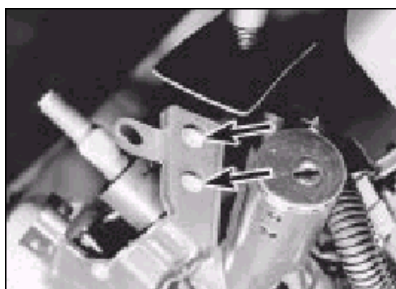
4.3 Šrouby kombinovaného přepínače na hřídeli volantu (šipka) – modely do roku 1992
