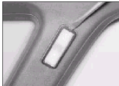
6.2a Vypáčte vnitřní osvětlení
