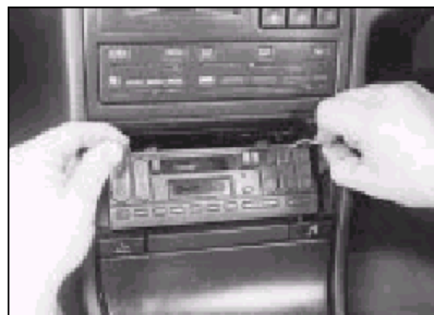
20.14 Vsuňte dráty do otvoru na vrcholu radiopřehrávače.
