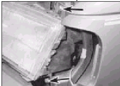
7.8 Vnější zajišťovací šrouby předního světla (šipka)
