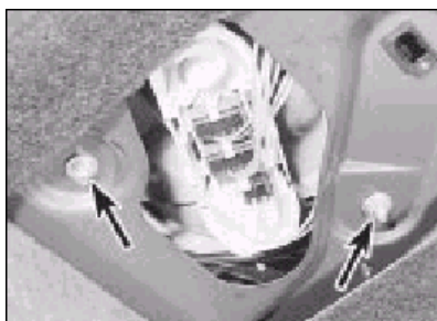
7.34c Matice zadního světla namontovaného v zadních výklopných dveřích - (šipka) - model kombi
