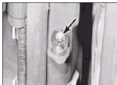
4.29 Odstraňte táhnutím gumovou manžetu zakrývající šroub spínače osvětlení (šipka)
