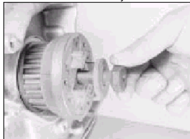
7.11a Odstraňte šroub řetězového kola klikové hřídele . . .
