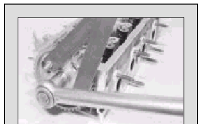
Použití domácího nástroje k zadržení rozvodového kola, zatímco je šroub utahován (zobrazen s odloženou hlavou válců).
