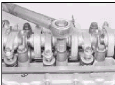
11.37b Postup práce v přitahování šroubu hlavy na 1 stupeň kroučícího momentu utažení . . .
