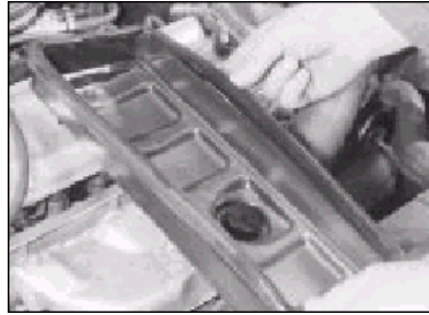
4.8 Při montáži, zabezpečte umístění gumového těsnění na krytu hlavy válců
