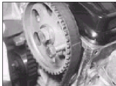
3.5 . . . vsuňte vrták o průměru 10 mm skrz seřizovací díрку v rozvodovém kole a zastrčte do dírky v hlavě válců
