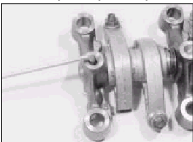
10.5b . . . pak odstraňte zajišťovací červík
