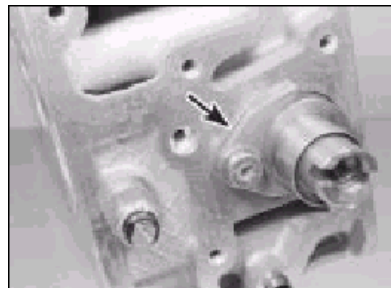
10.8 Uvolníte šroub a odstraňte zajišťovací vidlici váčkové hřídele (šipka) . . .
