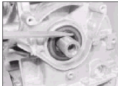
14.2 Použití šroubováku k odstranění těsnění oleje klikové hřídele
