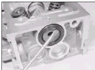
10.9a . . . vypáče olejové těsnění . . .
