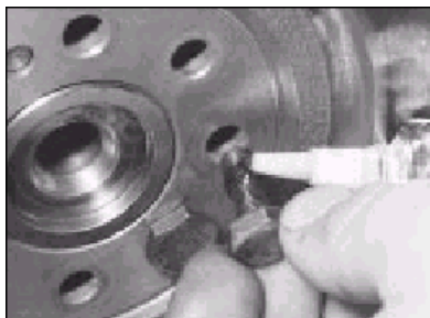
17.10 Jestliže nejsou nové závit šroubu setrvačnicku opatřené zajišťovací, použijte k zajištění směs. .
