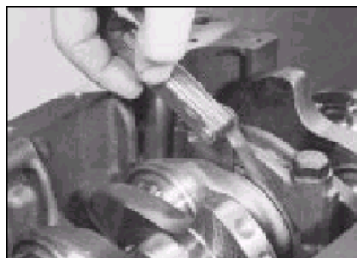
14.3 Kontrola axiální vůle klikové hřídele pomocí spárových měrek
