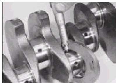
14.10 Měření průměru čepu ložiska ojnicí hlavy klikové hřídele
