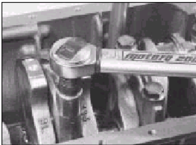
18.74a Po namontování všech víček utáhněte matice a šrouby na předepsaný moment . . .
