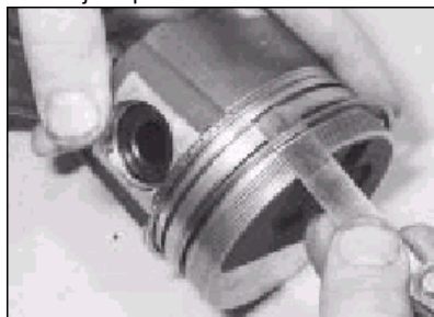
13.2 Odstranění pístního kroužku pomocí spárové měrky
