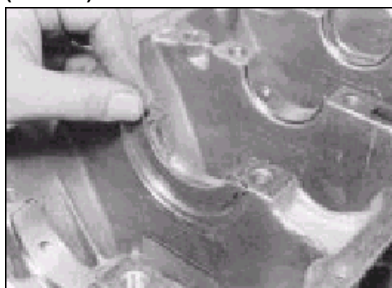
18.40 Montáž axiální podložky klikové hřídele – hliníkový blok motoru TU
