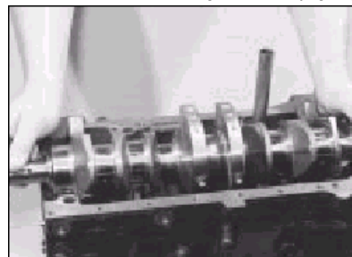
11.20 Vyjmutí klikové hřídele - řada motoru XU
