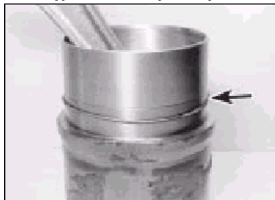
12.18b . . . a vyměňte spodní těsnicí O-kroužek (šipka)
