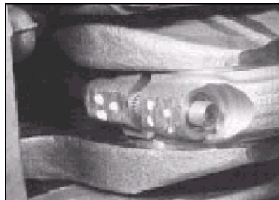
10.3 Spojení ojnice a ojniční hlavy ložiskové víčko označení k zjištění totožnosti (ukázán válec č. 3)
