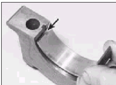
18.34 Na motorech XU, mají všechny spodní pánve ložiska rovný povrch. Zajistěte, že zoubek(šipka) je správně umístěn ve víku.
