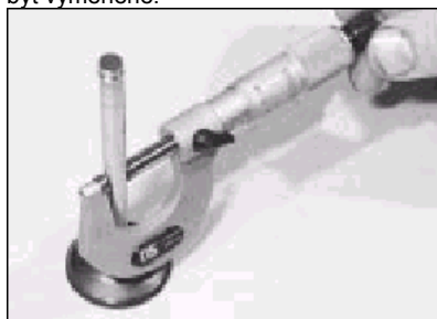
8.11 Měření průměru stonku ventilu
