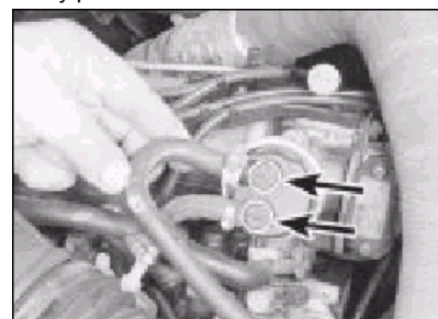
4.3 Šipky na palivovém čerpadle označují směr toku pohonné látky
