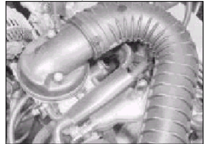
12.2 Potrubí čističe vzduchu- kryt škrťící klapky (jednobodové vstříkovací Magneti Marelli)
