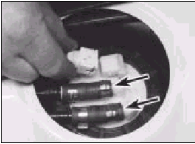
9.9 Odpojte konektor a potom uvolněte přívod paliva a vrátne hadice (šipka) z palivového čerpadla
