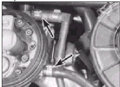
12.4 Spojky přívodní a vratné hadice paliva (šipka) - ukázán novější model
