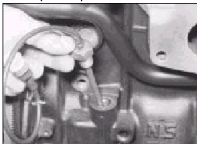
14.2 Odstranění snímače hladiny oleje z bloku motoru
