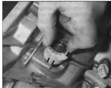
6.7c . . . a vložte vrchní otočný čep hřídele a vtlačte do převodové skříně - ukázána převodovka BE3
