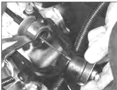
3.2a Povolte pojistnou a nastavovací matici spojkového lanka (kde je nutné), pak uvolníte vnitřní koncovku lanka zařízení ...
