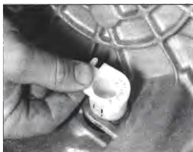
6.7a Vtlačte spodní pouzdro otočného čepu do převodové skříně
