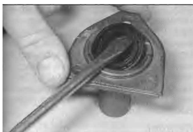
5.22 Odstraňte těsnění vstupního hřídele z objímky vodítka.
