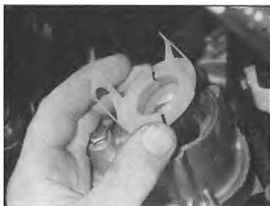
5.8a Vložte nové těsnění společně s umělým chráničem těsnění. . .
