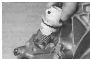
7.3b . . . pak odstraňte z převodovky náhon rychloměru (ukázán typ BE3)
