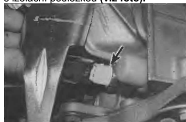
6.4 Odpojte konektory ze spínače zpětných světlometů (šipka)
