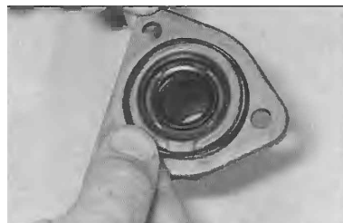
5.25a Použijte nové těsnění (O-kroužek) (podle použití) . . .
