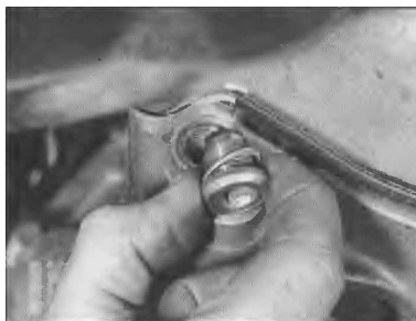
2.4 Odstranění kontrolního vodorovného šroubu a těsnicí podložky z převodovky (ukázán model 1.4 litru)
