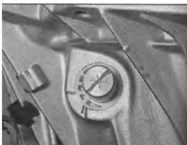
8.26a Na modelech s "tažnou" spojkou, seřaďte značky vypínací vidličky se značkami zhotovenými při demontování
