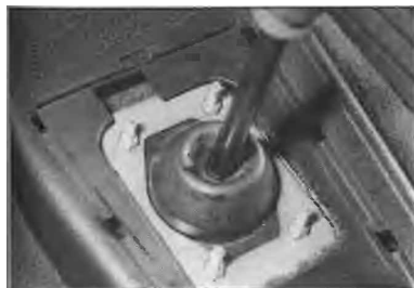
4.7 Povolte a odstraňte čtyři matice a odstraňte řadicí páku z pod vozidla
