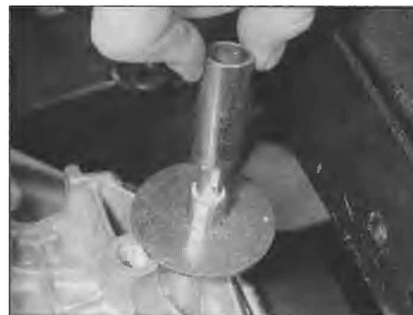
8.20a Na modelech 1,8 litru a větších stáhněte ze svorníku rozpěrku
