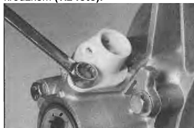
7.3a Povolte a odstraňte šroub . . .
