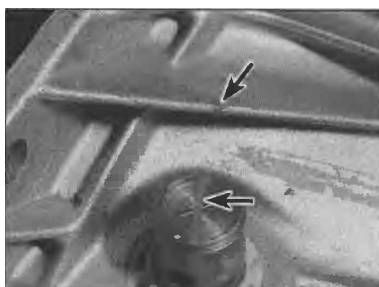
8.21c . . . a udělejte značku mezi hřídelí vypínací vidličky a převodovou skříní (šípky)
