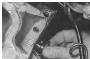
5.30b . . . pak stáhněte těsnění z hřídele
