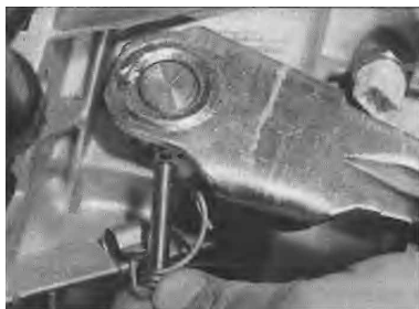
8.21a Na modelech s "tažnou" spojkou, odstraňte pojistný čep. . .
