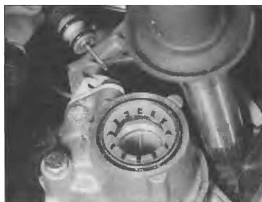
8.12b . . . a odpojte náhon rychloměru z převodovky - převodovka BE 4
