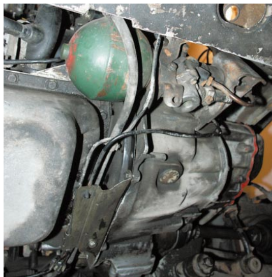
Tlakový regulátor a krycí plech prevodovky.
