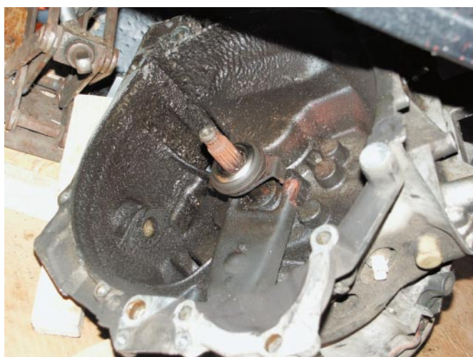
Prevodovka je von a ten bordel vnútri znamená netesnosť prevodovej skrine.
