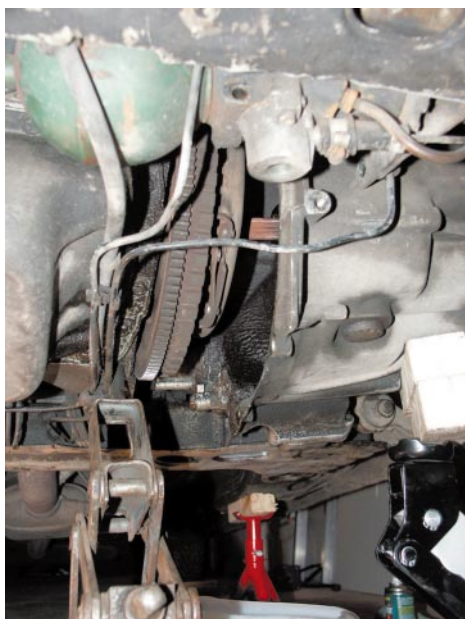
Prevodovka odpojená od motora.
