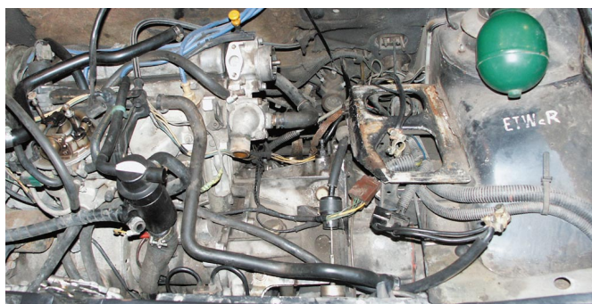
Vybratá batéria, vzduchový filter, chladič, odpojený rozdeľovač.
