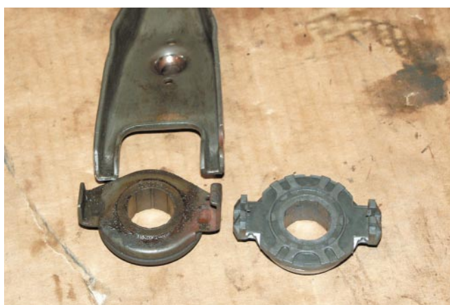
Spojkové ložisko, vľavo staré, vpravo nové.
