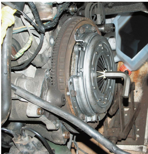
Nová spojka založená, strediaci prípravok z imbusu.
