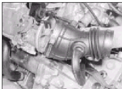
12.6 Odpojte plastické potrubí
